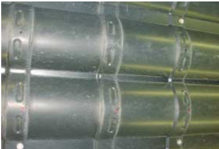
Afbeelding 5.9 Aardgastanks aan onderzijde voertuig
