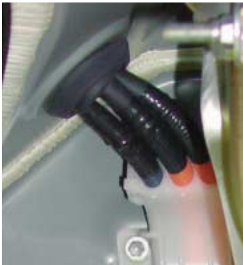
afbeelding 4.5 De hoge spanningskabel die van de HV-accu naar de motor loopt
