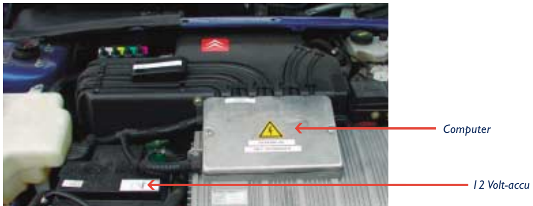
afbeelding 1.7 De 12 Volt-accu en de computer (Saxo; voor de Berlingo is het beeld vrijwel gelijk)
