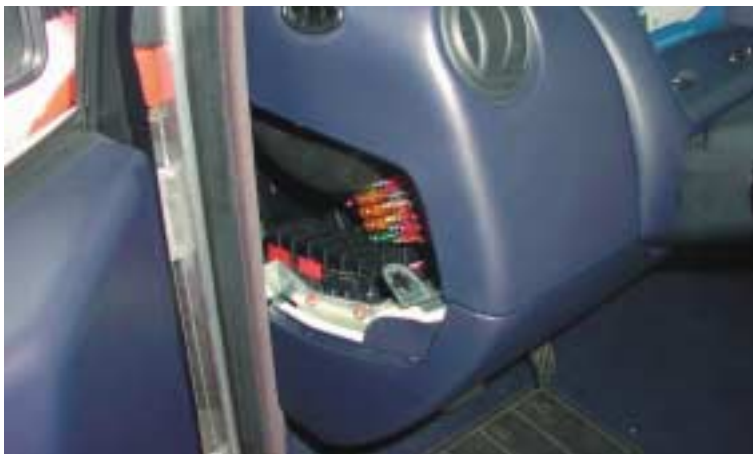
afbeelding 2.5 De zekering voor de 12 Volt-accu
