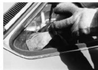
lossnijden rubbers met een haakmes en met een plamuurmes
