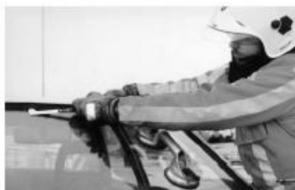
lossnijden rubbers met een haakmes en met een plamuurmes
